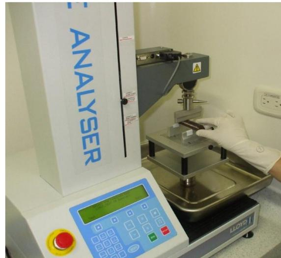
Tabla 1. Coeficientes de variación de fuerza de fractura de chocolate a diferentes condiciones de operación de la máquina universal de ensayos de columna sencilla TAPlus
