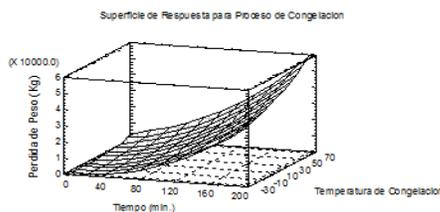
La figura anterior describe la incidencia de las variables temperatura de congelación, pérdida de peso y el tiempo. Mediante análisis multivariado, se puede comprender la relación sinérgica presente en el proceso. La siguiente ecuación, de segundo orden; obtenida mediante el software estadístico STATGRAPHICS Centurion Versión XV, con un  $r^2=0.995$ ; corrobora la relación antes descrita.
