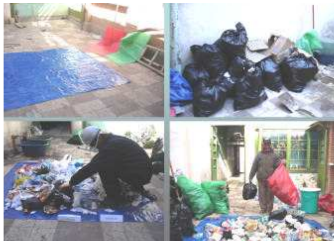
Figura 3. Procedimiento del cuarteo de los residuos sólidos.
