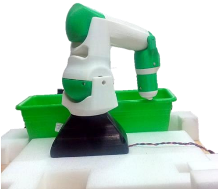
Figura 4 Robot antropomórfico ensamblado
