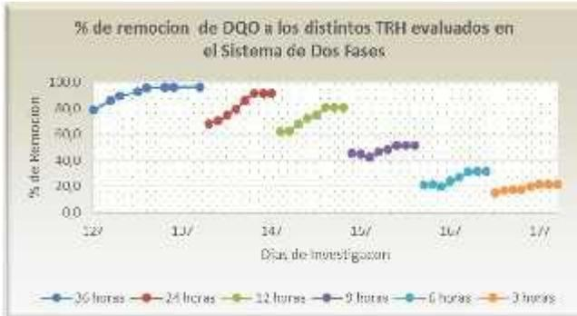
Analizando el comportamiento del sistema de dos fases (Acidificador y UASB) la (Tabla 3) nos muestra que a TRH de 24 horas es el mejor tiempo tanto para remoción de SST como para SSV con un 78,52% y 81,27% respectivamente, a TRH de 12 horas el sistema sigue demostrando su gran eficiencia arrojando altos porcentaje de remoción, a TRH 9, 6 y 3 horas hay una notoria disminución del rendimiento del sistema.
