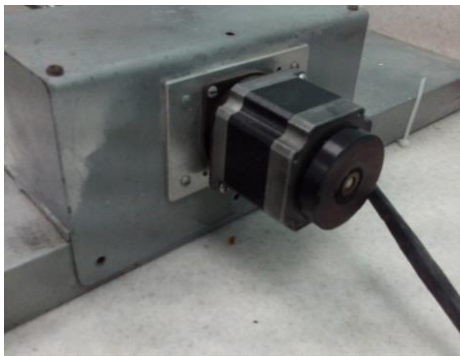
Fig. 4. Motor paso a paso STP-58D211-02. (Fuente: Autor).
